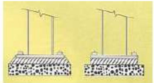
Las áreas expuestas fuera del borde de las placas se recomienda cortarse a plomo o a 45° después de que ha fraguado suficiente para soportarse solo (2 a 3 horas después de su aplicación).
